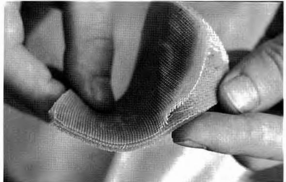
Figura 19: Resinas termofusionadas. Observen la gran maleabilidad que ofrecen a 70 grados y sin riesgo a sufrir quemaduras.
