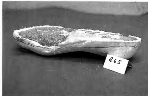
Figura 17: Moldes rellenos de resina.
