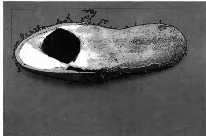
Figura 38: Visión plantar con la resina de poliéster incluida.
