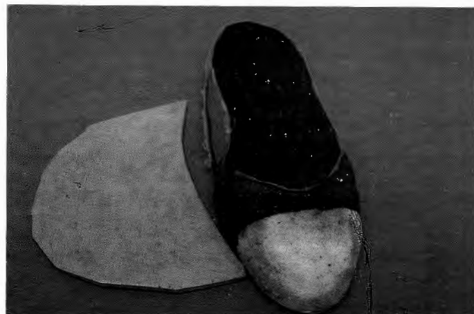
Figura 39: Aplicación de una puntera de evaliegère.
