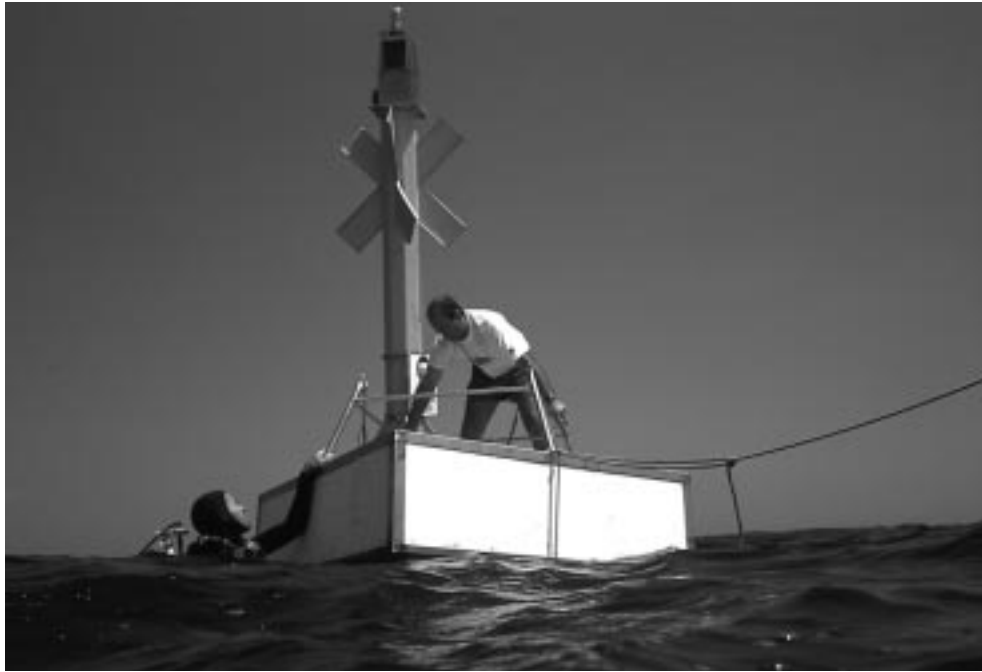
Fig. 4. Part emergida del mesocosm ancorat a la boia.
