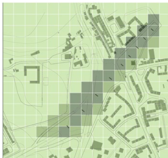
Imagem 84: Sombra diária do viaduto do Eixo Norte-Sul (verde muito claro - área insolada; verde claro - parcialmente ensombrada; verde escuro - totalmente ensombrada)
