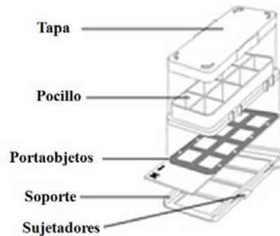
**Figura 2.** Esquema representativo de un portaobjetos de 8 pocillos. **Merck Millipore**
