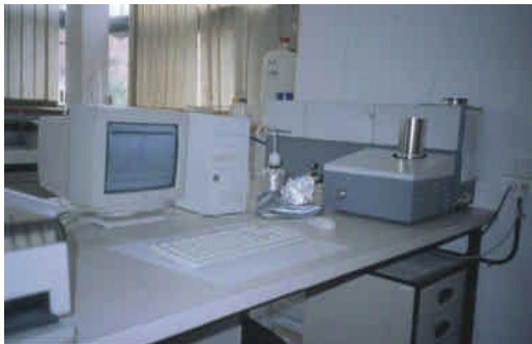
Figura 29.- Fotografía del Coulter LS100 instalado en el Departamento de Estratigrafía, Paleontología y Geociencias Marinas de la Universidad de Barcelona
