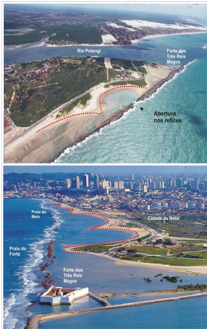
Figura 14b – Formato das Praias do Forte e Praia do Meio, devido os efeitos de difração ocasionado nas ondas incidentes que ultrapassam a linha de recifes.
