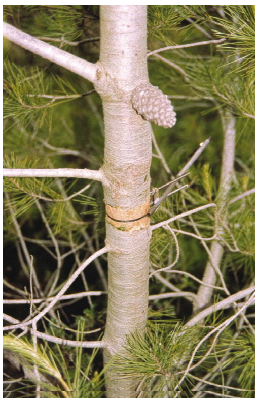
Figura 8. Dendrómetro de banda instalado en un pino carrasco en la localidad de estudio, Garraf.
