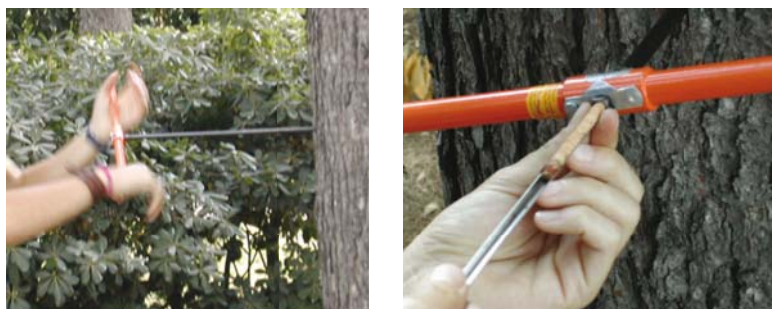
Figura 4. Extracción de un testigo de madera mediante el empleo de una barrena Pressler.
