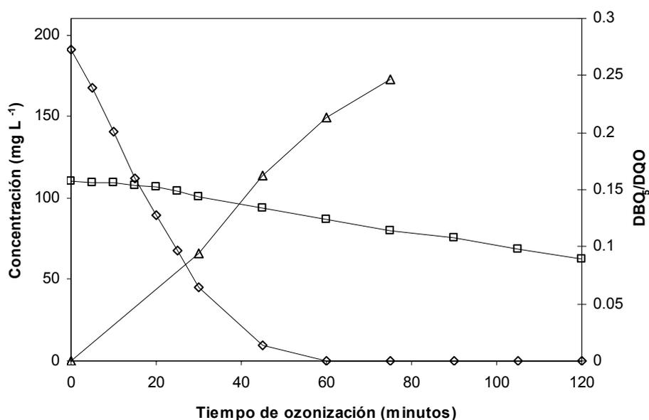
Figura 1 - Ozonización de una solución de 4-CP a 200 mg L<sup>-1</sup> utilizando una dosis de ozono de 7.57 g h<sup>-1</sup>.
