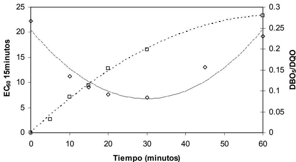
Figura 6 – Evolución de la Biodegradabilidad y de la toxicidad durante la ozonización del SMX. □ = Ratio DBO<sub>5</sub>/DQO; ◇ = EC<sub>50</sub> en 15 minutos. 20 °C y pH no ajustado.
