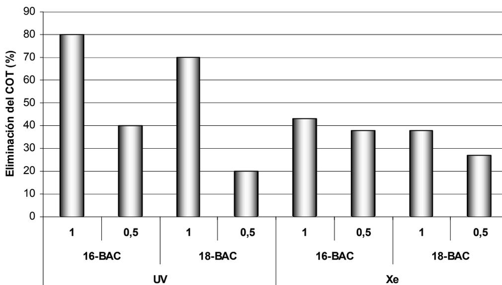
Figura 4 – Eliminación de COT después de 90 minutos de tratamiento con foto-Fenton con diferentes proporciones de  $H_2O_2$ /tensoactivo.
