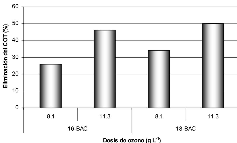
Figura 3 – Eliminación del COT de los compuestos 16 y 18-BAC después de 90 minutos de ozonización.
