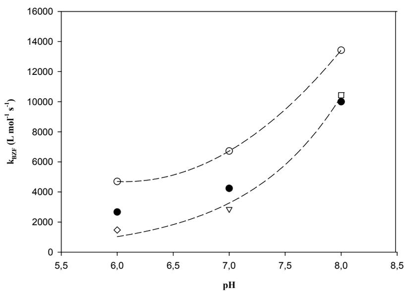
Figure 8 – Valores de las constantes cinéticas para la ozonización de BZF versus el pH obtenidos mediante el metodo absoluto (●) y por el método de la competición usando los
