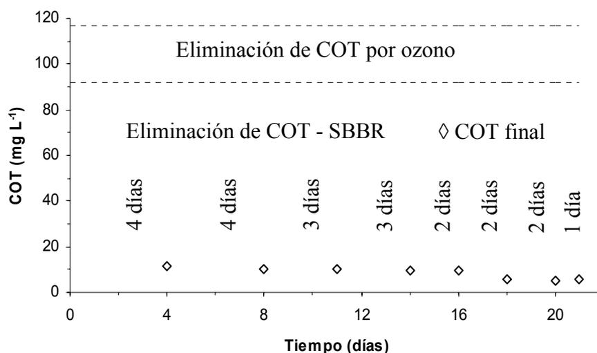
Figura 2 – Eliminación de COT mediante la combinación ozonización-SBBR.
