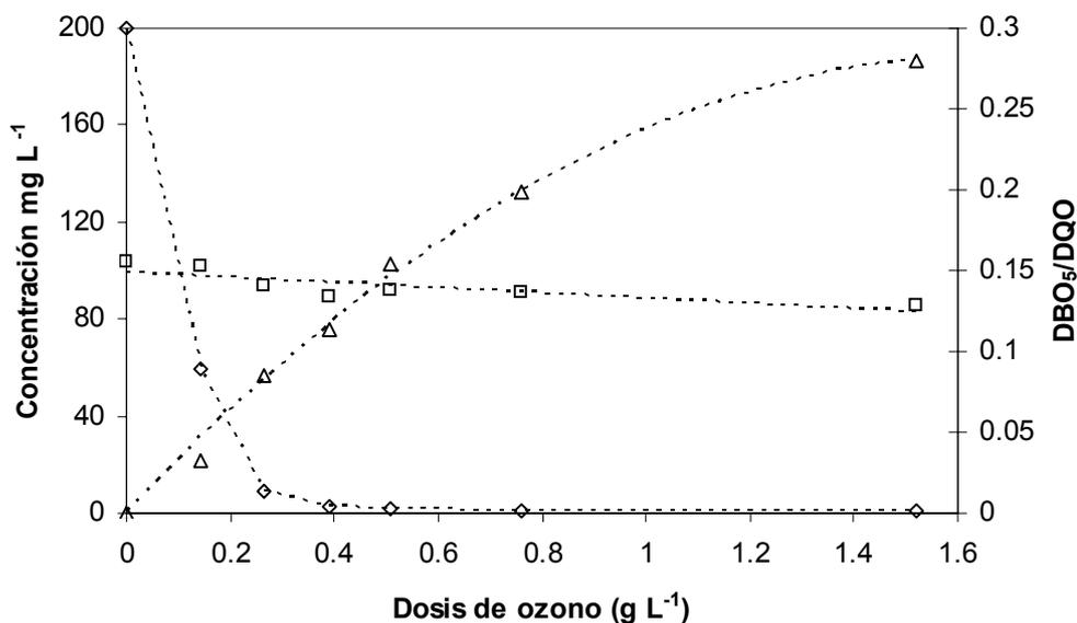
Figure 5 – Ozonización del sulfametoxazol.  $\diamond$  = concentración del SMX;  $\square$  = COT;  $\Delta$  = BOD<sub>5</sub>/COD. 20 °C y pH no ajustado.
