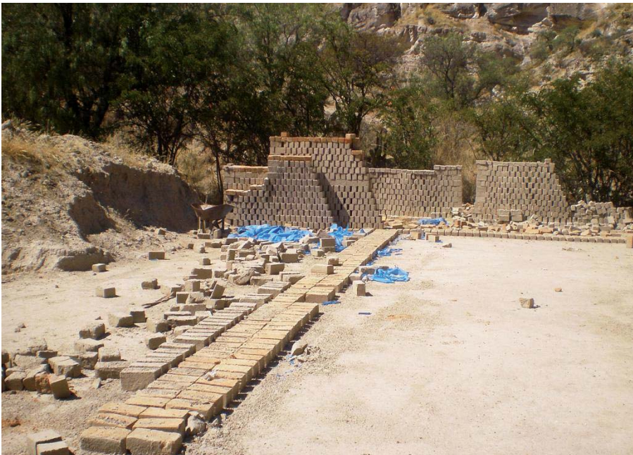
Cerca de Wari, Ayacucho. Los ladrillos crudos se disponen en las proximidades del horno en ordenamientos y seriaciones para su secado al sol, y una vez secos, en apilamientos para su almacenamiento en espera de la cocción final. La técnica de elaboración de ladrillos es heredera de la antigua tradición alfarera artesanal. (foto: V. Crousse)
