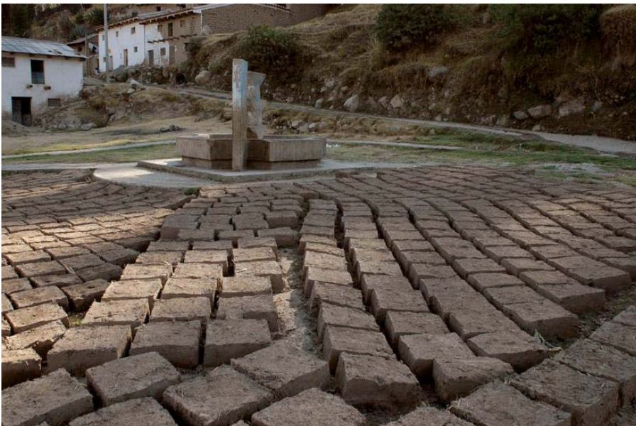
El material de los adobes, hechos de tierra y paja secados al sol, es el mismo que el de las viviendas, el de los caminos y del paisaje circundante. (foto: V. Crousse)
