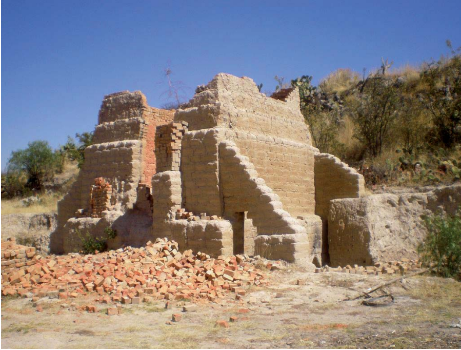
Cerca de Wari, Ayacucho. Las ladrilleras son grandes hornos abiertos para la elaboración y cocción artesanal de ladrillos. En el proceso de elaboración, se utiliza la tierra del lugar como materia prima para la elaboración manual de los ladrillos. (foto: V. Crousse)
