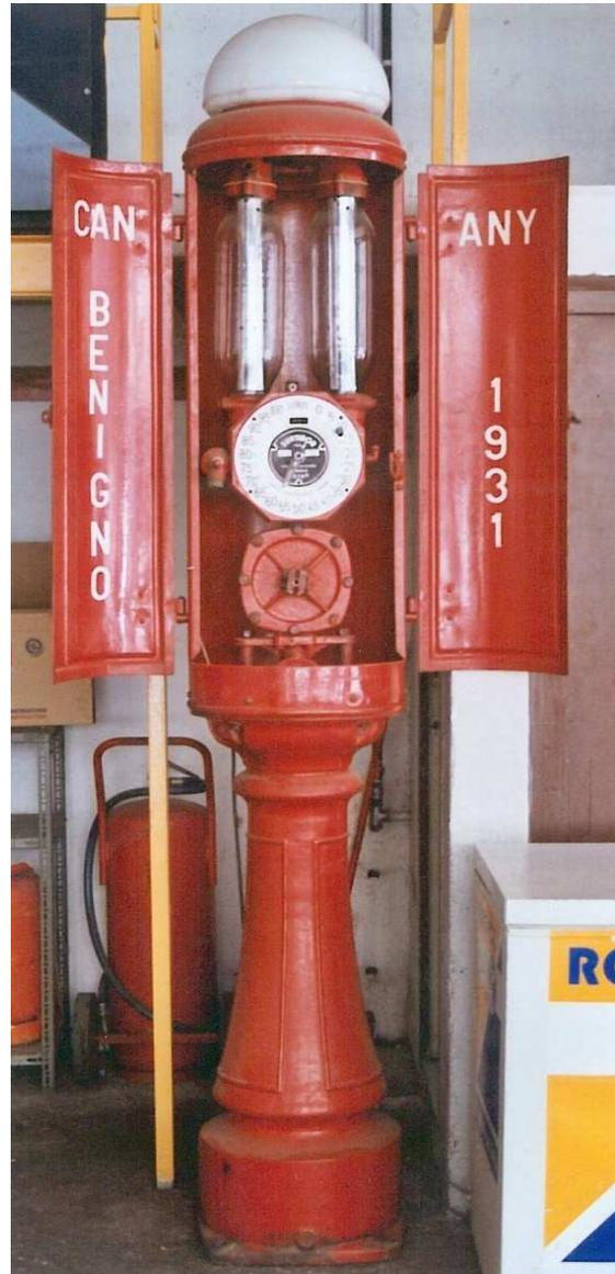
Surtidor o poste de gasóleo hoy en desuso, pero utilizado con regularidad hasta la segunda mitad del siglo pasado. Era una bomba manual, pintada de color rojo y con medidores para el suministro. Extraía el combustible de un depósito subterráneo y servía tanto para el repostaje de los vehículos de tracción como de la maquinaria pesada agrícola en general. Este derivado del petróleo es el
