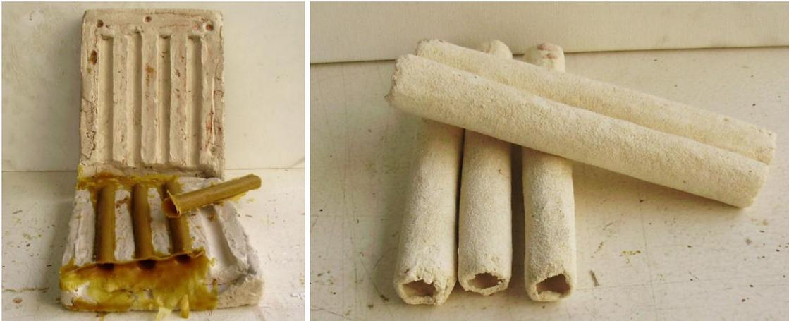
Figura II.16. Molde de cilindros (izquierda). Cilindros huecos de cascarilla cerámica (derecha).
