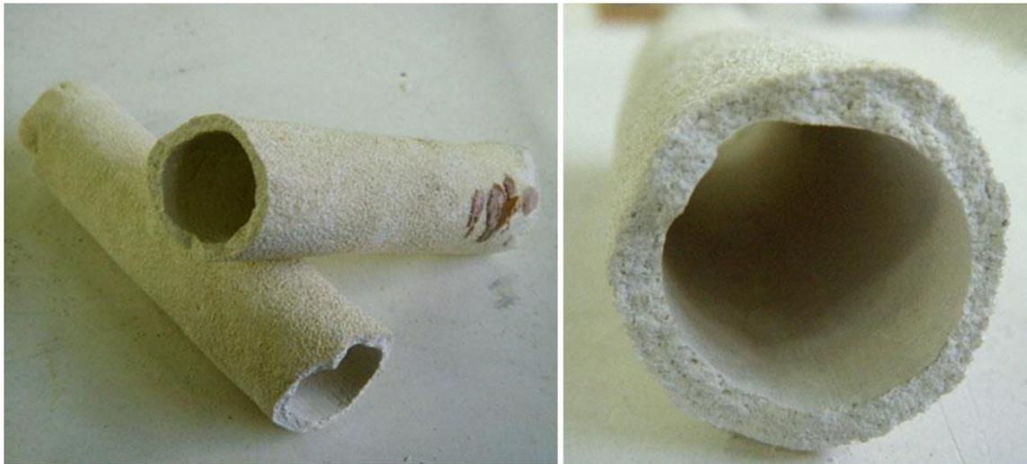
Figura II.19. Cilindros después de la rotura (izquierda). Vista frontal de la rotura del cilindro (derecha).
