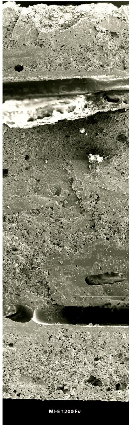
Figura II.54. Imagen de la microestructura de la cascarilla cerámica m1-5F cocida a 1200°C.
