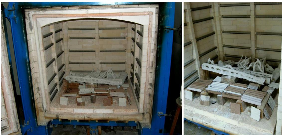
Figura II.12. Horno eléctrico para descerado Plasasó. Ubicado en la "Fonería"-UB.
