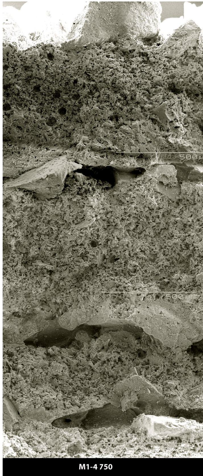
Figura II.47. Imagen de la microestructura de la mezcla m1-4 cocida a 750°C.
