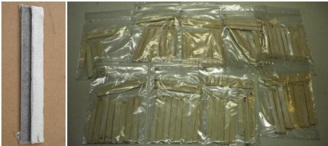
Figura II.21. Conformación de la plaqueta de cascarilla sobre el soporte de hierro recubierto de cinta adhesiva (izquierda). Todas las plaquetas de cascarilla cerámica divididas por composición y cocción (derecha).
