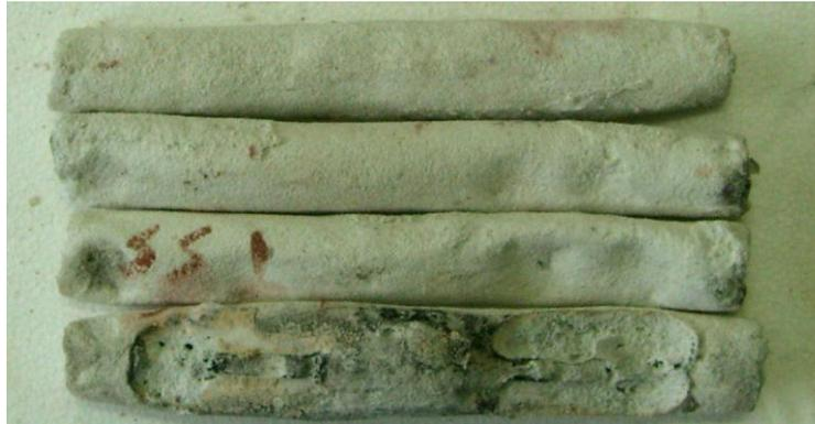
Figura II.17. Cilindros de Carsil 9 deformados después de la cocción.
