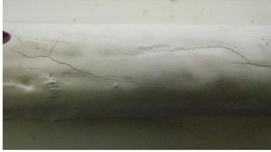
Figura II.28. Probeta de cascarilla cerámica de sólo papilla con grietas en su superficie.
