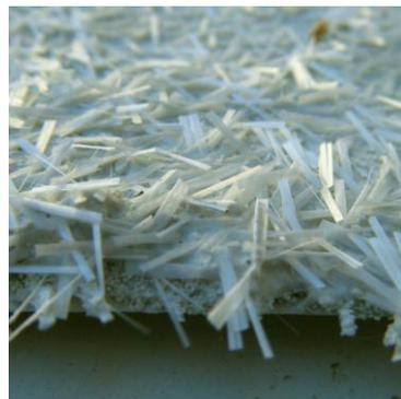
Figura II.7. Rebozado de fibra cortada de 6 mm.
