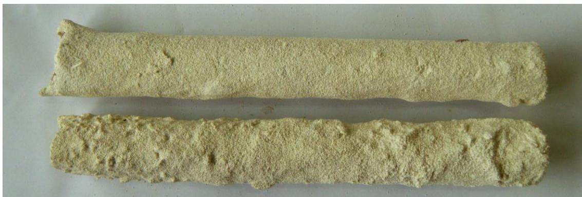
Figura II.18. Cilindros de cascarilla cerámica recubiertos con sólo rebozado de Moloquita 50-80dd (cilindro de arriba), cilindro con introducción de fibra de vidrio (cilindro de abajo).
