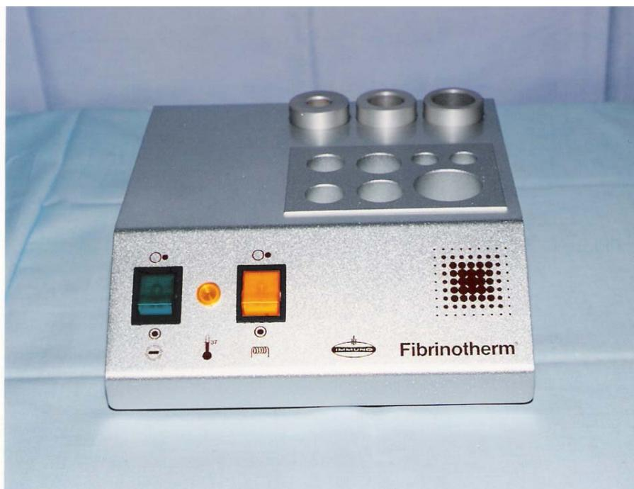
Fig. 55. Aparato de calentamiento y agitación Fibrinotherm.
