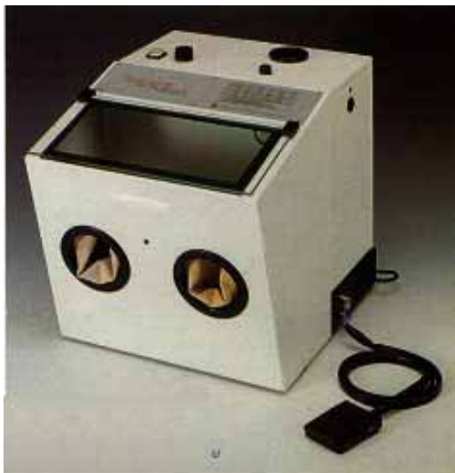
Figuras FME6 y FME7. Aparataje empleado para la limpieza superficial de las muestras. Arenadora modelo Base 1 Plus (izquierda) y compresor de aire (derecha).
