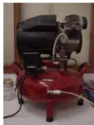
Figuras FME6 y FME7. Aparataje empleado para la limpieza superficial de las muestras. Arenadora modelo Base 1 Plus (izquierda) y compresor de aire (derecha).
