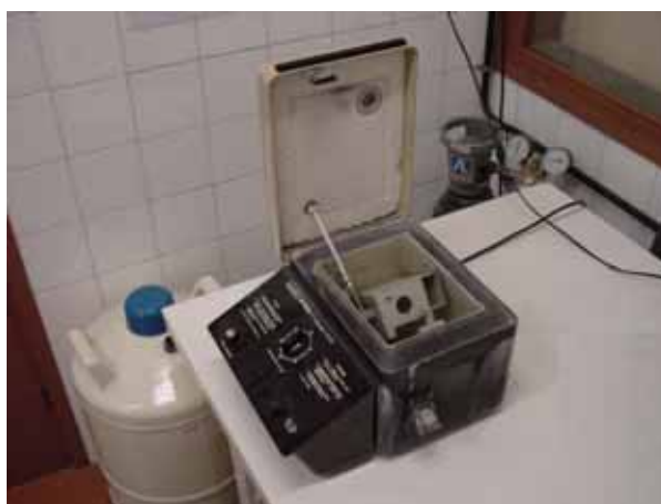
Figura FME8. Molino refrigerado con nitrógeno líquido (Spex 6700) empleado para la tritución de las muestras de la presente tesis doctoral.
