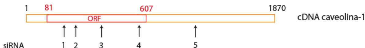
Estas secuencias y sus complementarias fueron transcritas *in vitro* y anilladas en forma de RNA de doble cadena mediante el “*silencer siRNA construction Kit*” de Ambion, tal y como se explica en el apartado 2.2 de la sección Materiales y Métodos.
