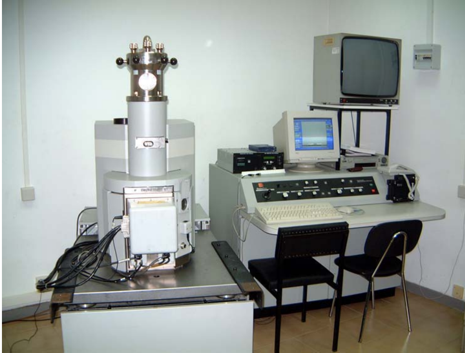
Fig. 49. Microscopi electrònic de Rastreig ambiental de la UPC utilitzat en aquest estudi.
