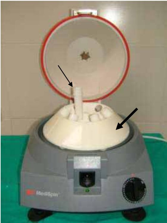
Figura 21: Centrífuga Medilite 2581 para el decantado del material obtenido por aspiración. La flecha gruesa indica el rotor y la flecha delgada los cilindros donde se depositan las jeringuillas.
