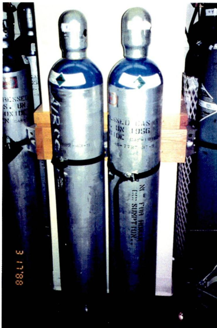
*Figura 9.* Cilindro de óxido nítrico utilizado en este estudio. El óxido nítrico está almacenado en nitrógeno puro a una concentración de 800 partes por millón (ppm); capacidad del cilindro 40 litros.
