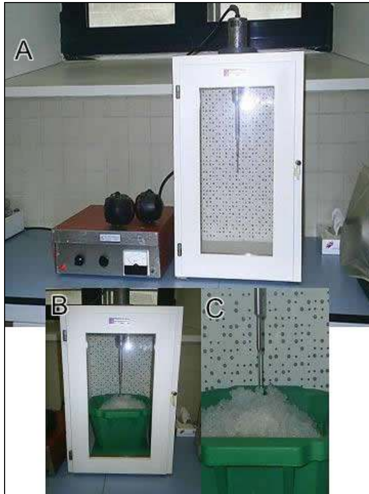
Fig 3.2 Sonicador i col·locació de la mostra. Com s'observa a C, la mostra ha de ser processada en gel, per les elevades temperatures que s'assoleixen amb el tractament i que podrien introduir canvis en la composició proteica de la mostra.
