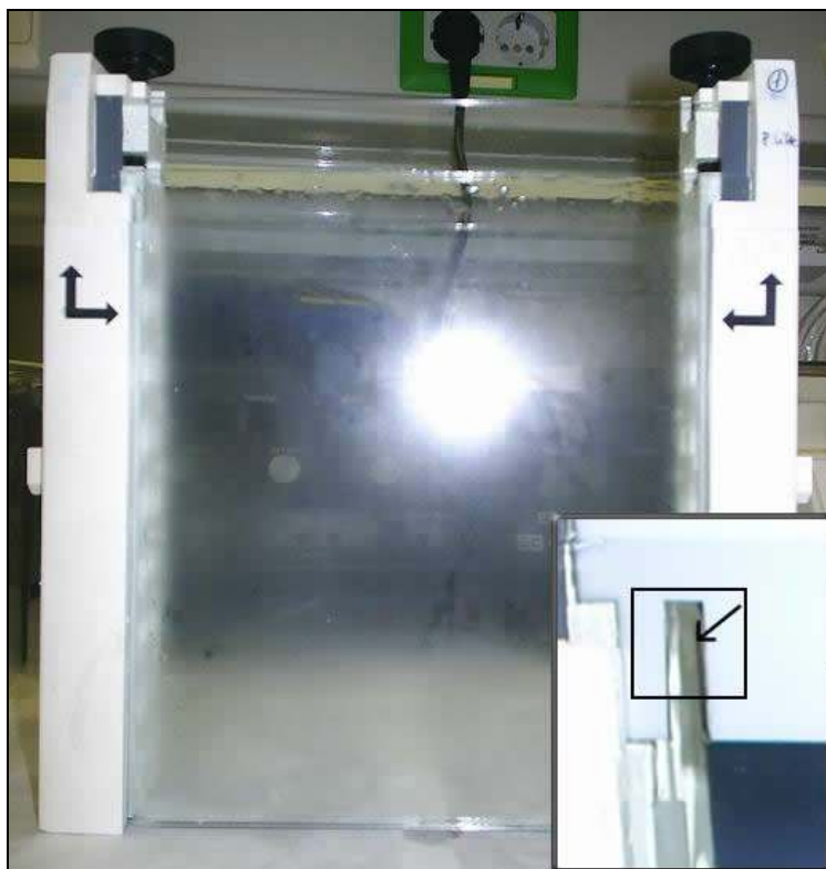
Fig 3.7 Gel d'acrilamida polimeritzat, i ampliació. A l'ampliació es pot veure la línia (indicada per una fletxa) que ens indica que hi ha un canvi de fase entre la fase aquosa i l'acrilamida; aquesta línia es indicadora de la polimerització del gel.
