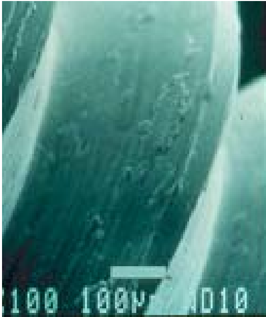
Figura 14. Micrografía de la superficie mecanizada del implante tipo b (MK III ® , Nobel Biocare, Goteborg, Suecia).
