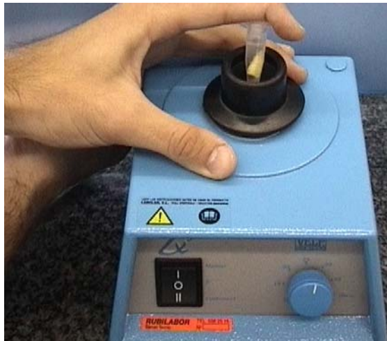
Figura 30. Aplicación de vibración sobre el eppendorf que contiene el diente y la solución de Ringer.
