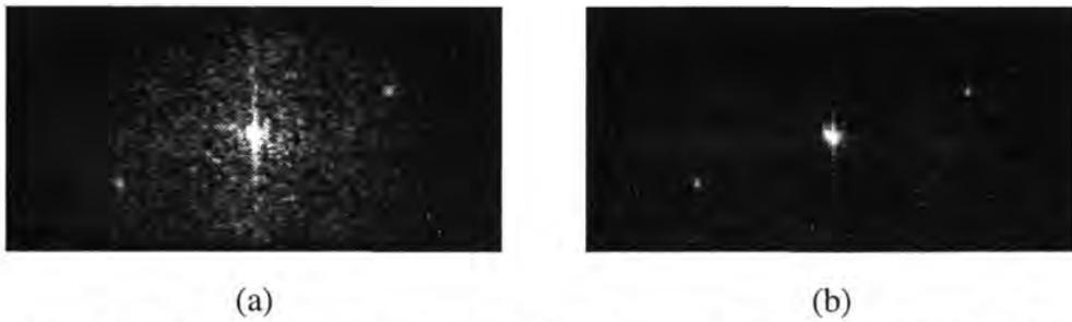
**Figura 5.16:** plano de correlación para el BJTC con el umbral (a) fijo igual a la mediana y (b) variable.
