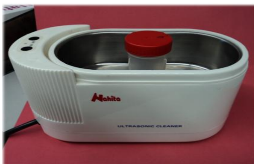
Figura 2.18. Imagen del baño ultrasónico utilizado para el ataque químico del Foturan con HF.
