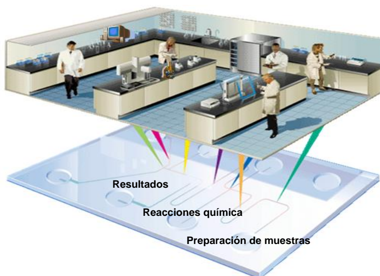
Figura 1.5. Dibujo esquemático del funcionamiento de un sistema lab-on-a-chip .
