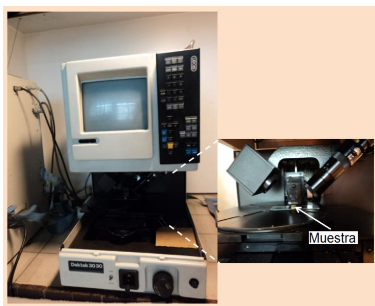
Figura 2.20. Imagen del perfilómetro utilizado para determinar la profundidad de los microdepósitos.
