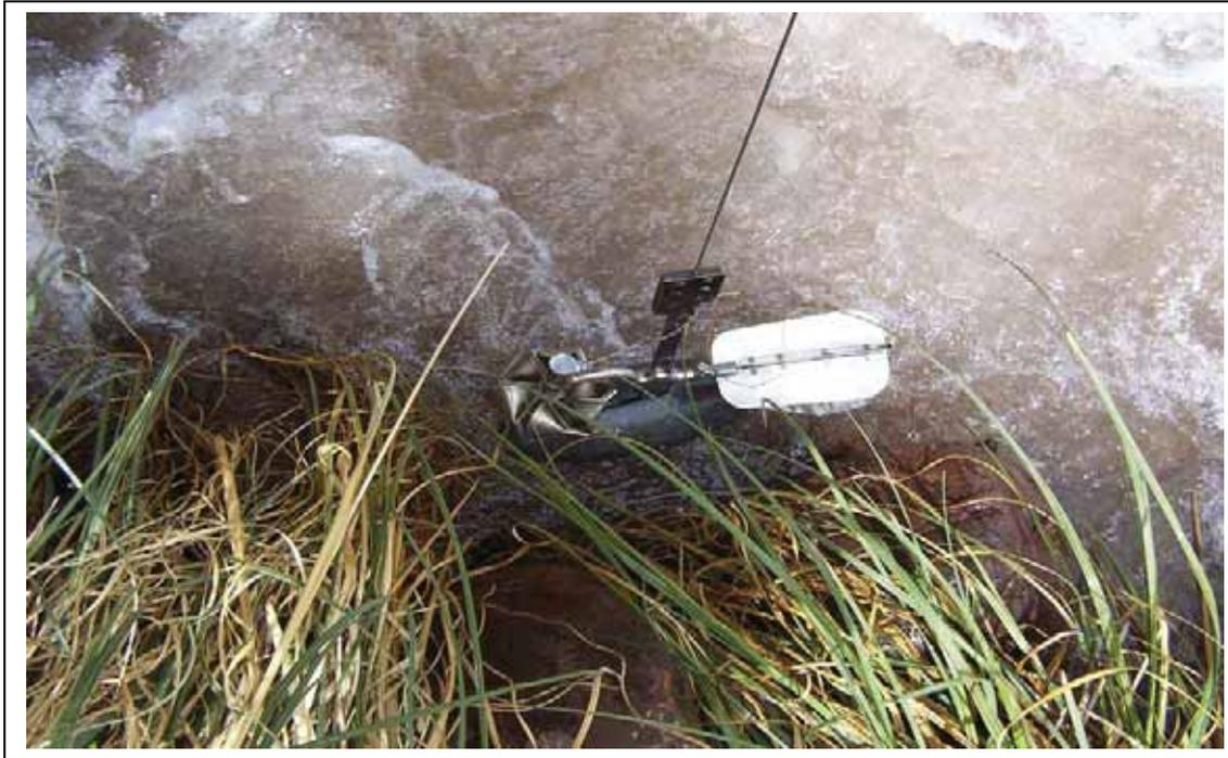
Fotografía 14: Correntómetro a punto de sumergirse en el estero Morales, al encontrarse en un sector poco profundo el escandaio toca el lecho y el molinete no puede girar. (fotografía: Infante, N. 2006.)
