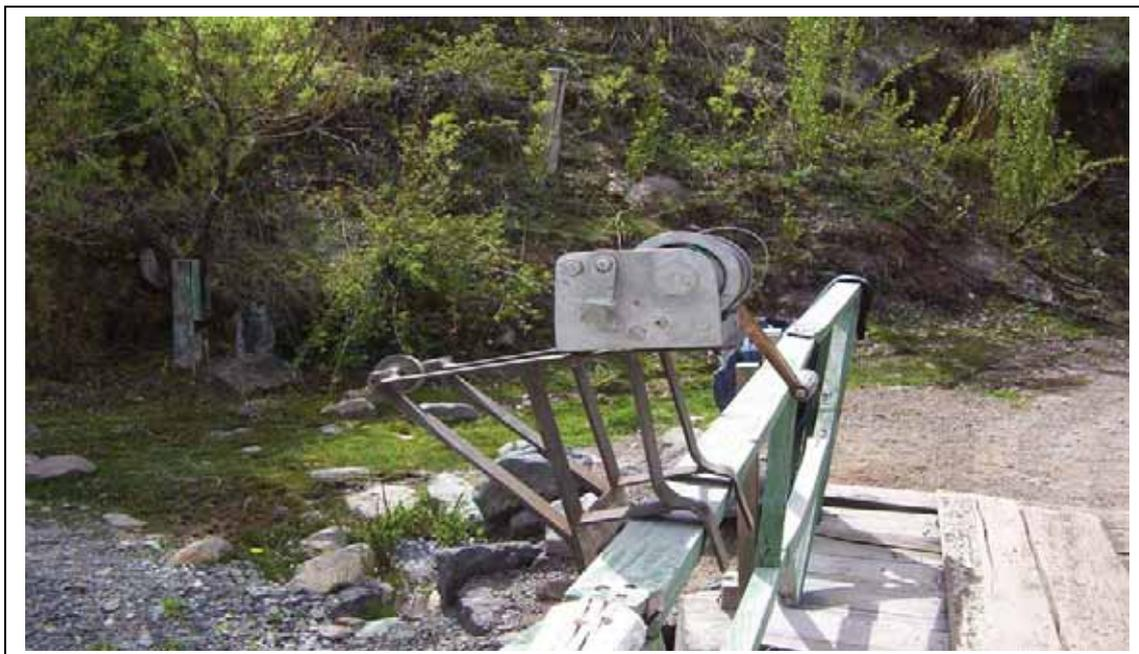
Fotografía 11: Dispositivo metálico artesanal diseñado para soportar el correntómetro en la medición del caudal. (fotografía: Infante, 2006.)
