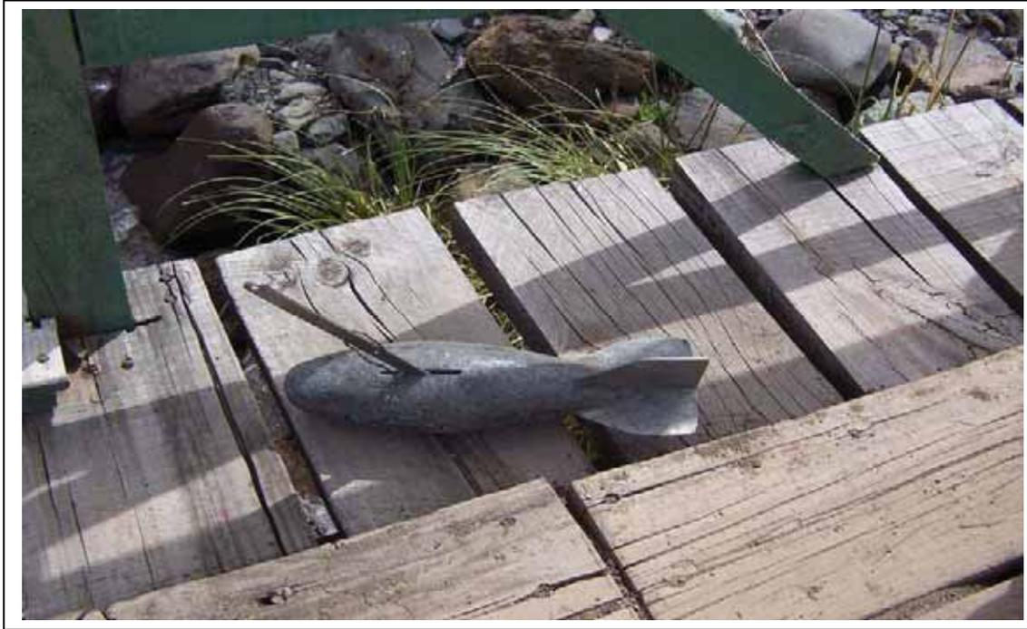
*Fotografía 12: Escandaio de 25 kg., utilizado para el peso del correntómetro. (fotografía: Infante, N. octubre 2006.)*
