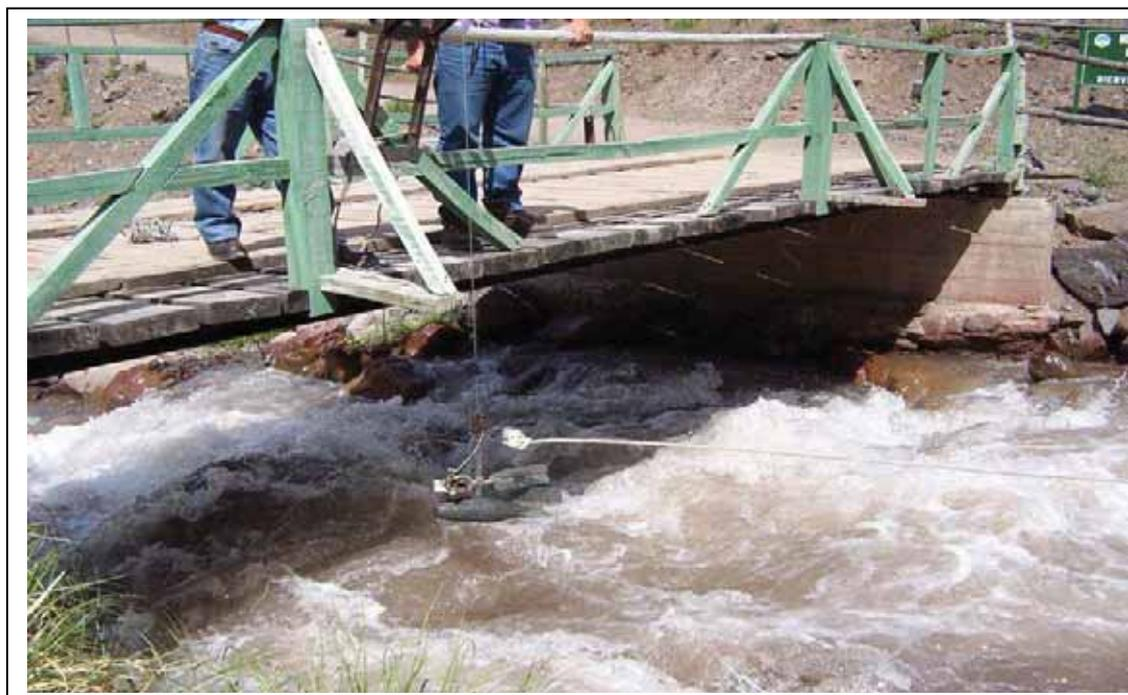
*Fotografía 10: Medición instrumental sobre el lado norte del puente el Esfuerzo, por personal de la DGA.. (Fotografía: Infante, N. noviembre, 2005).*
