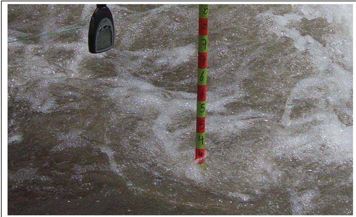
Fotografía 7: Medición de profundidad en las secciones elegidas con unas pértigas, en este caso, el nº 4 de color rojo representa a 35 cm., de profundidad bajo el agua. (fotografía: Infante, N. diciembre 2005 ).
