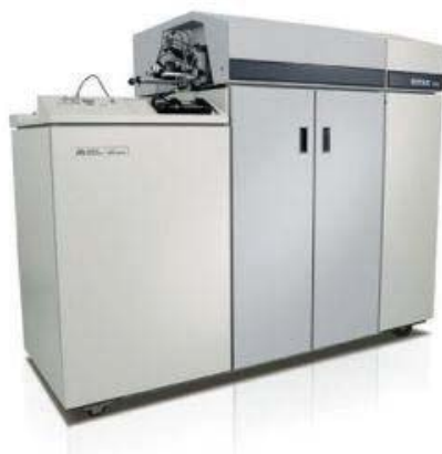
Figura 12. Espectròmetre de masses QToF-MS amb font d' ESI .
