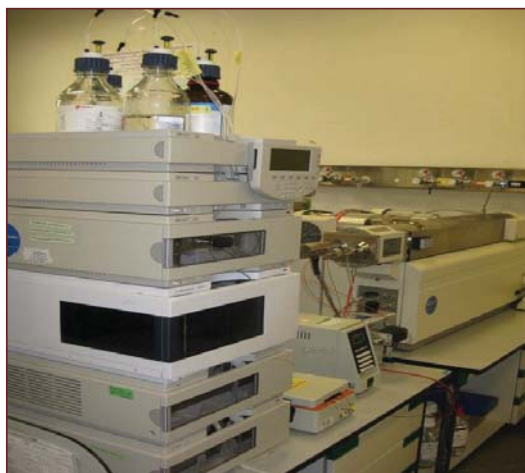
Figura 10. Espectròmetre de masses QqQ amb font d' ESI .
