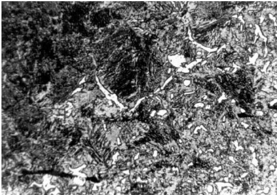
PT/2058/1. Fotografia 6. Cadenes cementítiques intergranulars sobre fons perlític, en algun cas fragmentades (x 350 augm.).
