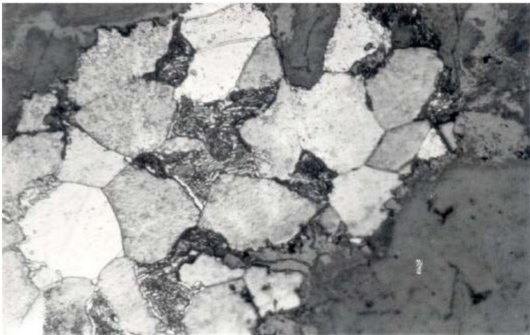
PT/2056/1. Fotografia 6. Grans perlítics, amb cementita laminar, entre grans ferrítics (x 900 augm.).
