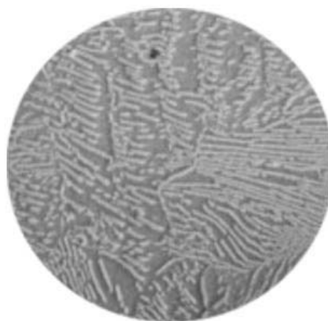
Figura 21. Estructura amb gra perlític laminar (x 875 augm.) (de cap. 9.1.2., fot. 2002/8/2).
