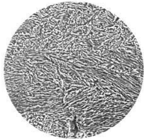
Figura 25. Estructura de bainita inferior (x 1100 augm.) (de cap. 9.6.2., fot. 2064/2/3).
