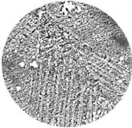
Figura 24. Estructura de bainita superior en forma de ploma d'au (x 4100 augm.) (de cap. 9.3.2., fot. 2040/1/3).
