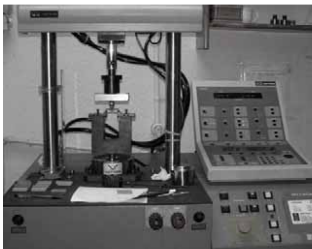
Figura 4.18. Aparell Instron 8511 utilitzat per als test de resistència i tenacitat a la fractura (Laboratori de la UPC)
