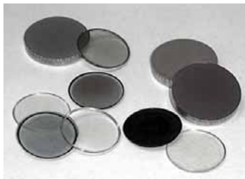
Figura 4.4. Preparació de la pols de les mostres amforals en perles i pastilles per a l'anàlisi de FRX
