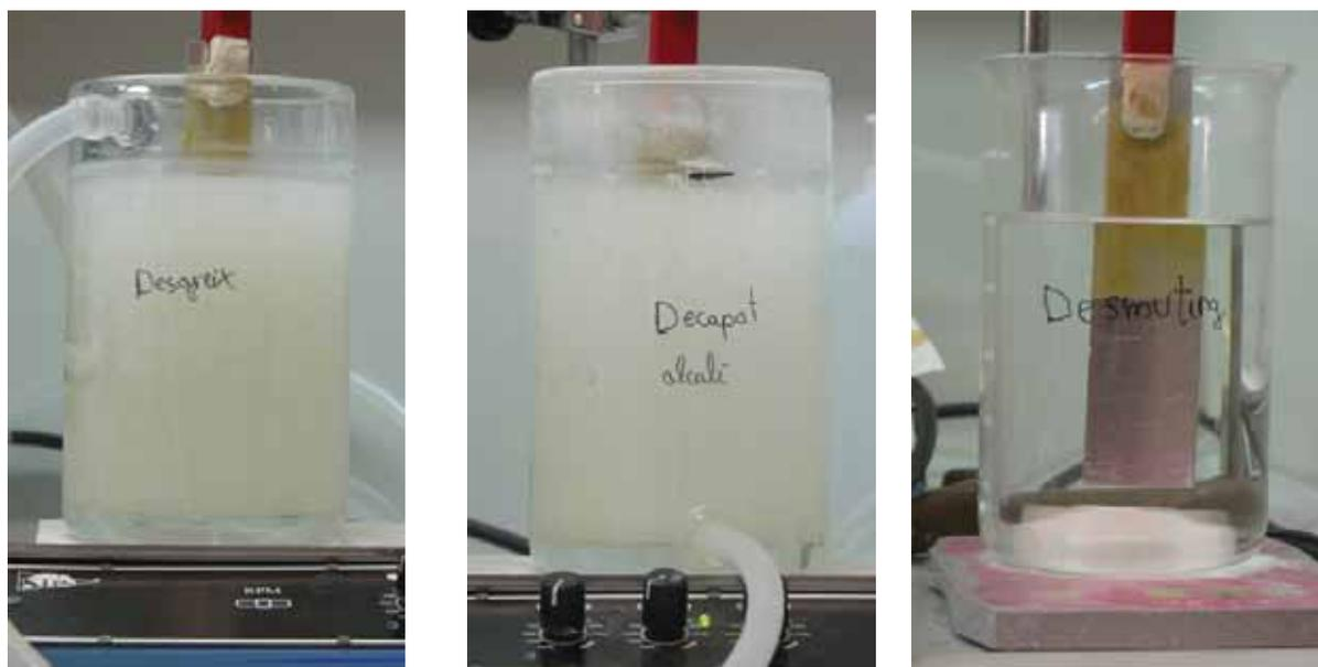
Figura 2.1 Sistema experimental utilitzat pel desgreixatge (1), el decapatge alcalí (2) i el decapatge àcid (3).
