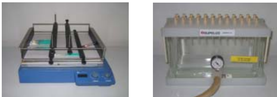
Figura 6.1. Esquerre: Agitador de vaivé emprat en la síntesi en fase sòlida. Dreta: Aparell per filtrar i rentar la resina, de la casa Supelco.
