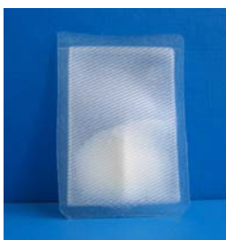
Figura 12.1. Bossa de te amb 100 mg de resina Rink-amida emprada per a la síntesi de la quimioteca de pentàmers.
