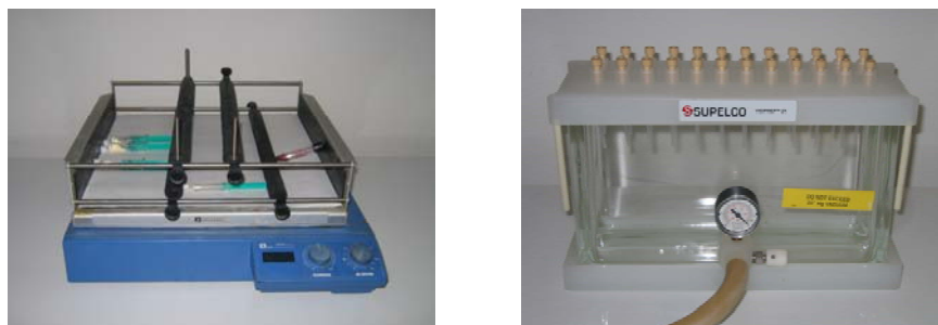
Figura 7.1 Esquerra: agitador de vaivé emprat en la síntesi en fase sòlida. Dreta: aparell per filtrar i rentar la resina, de la casa Supelco.
