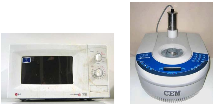
Figura 14.2 Esquerra: microones d'ús domèstic emprat per la síntesi de peptoides. Dreta: microones d'ús comercial emprat per la síntesi de la quimioteca.
