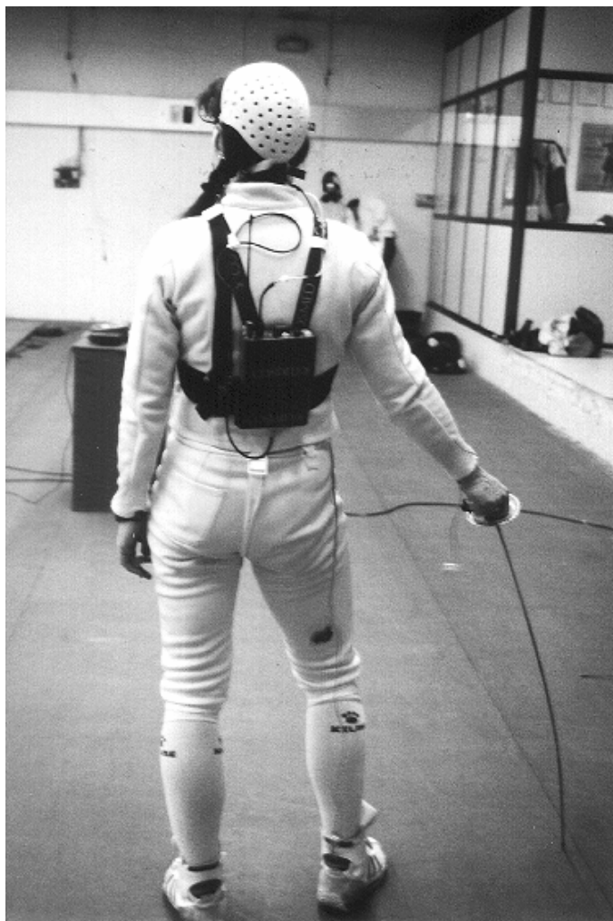
Foto 4-4: Visió posterior de la disposició de l'analitzador telemètric de gasos en una de les esgrimidors de la mostra.
