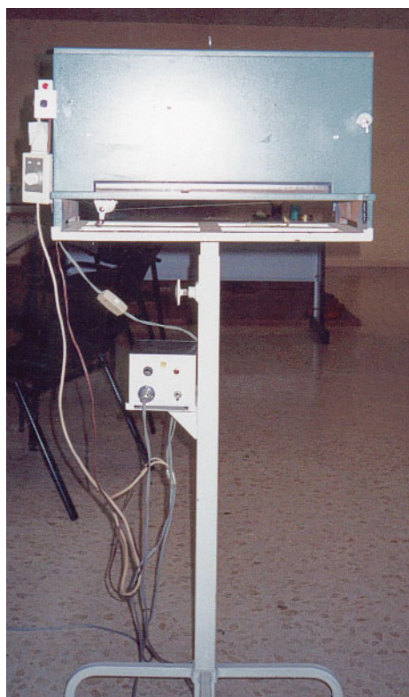
FIGURA 24. Vista lateral de l'aparell TKK-122 A . A la part superior esquerra es pot veure el potenciòmetre utilitzat.
