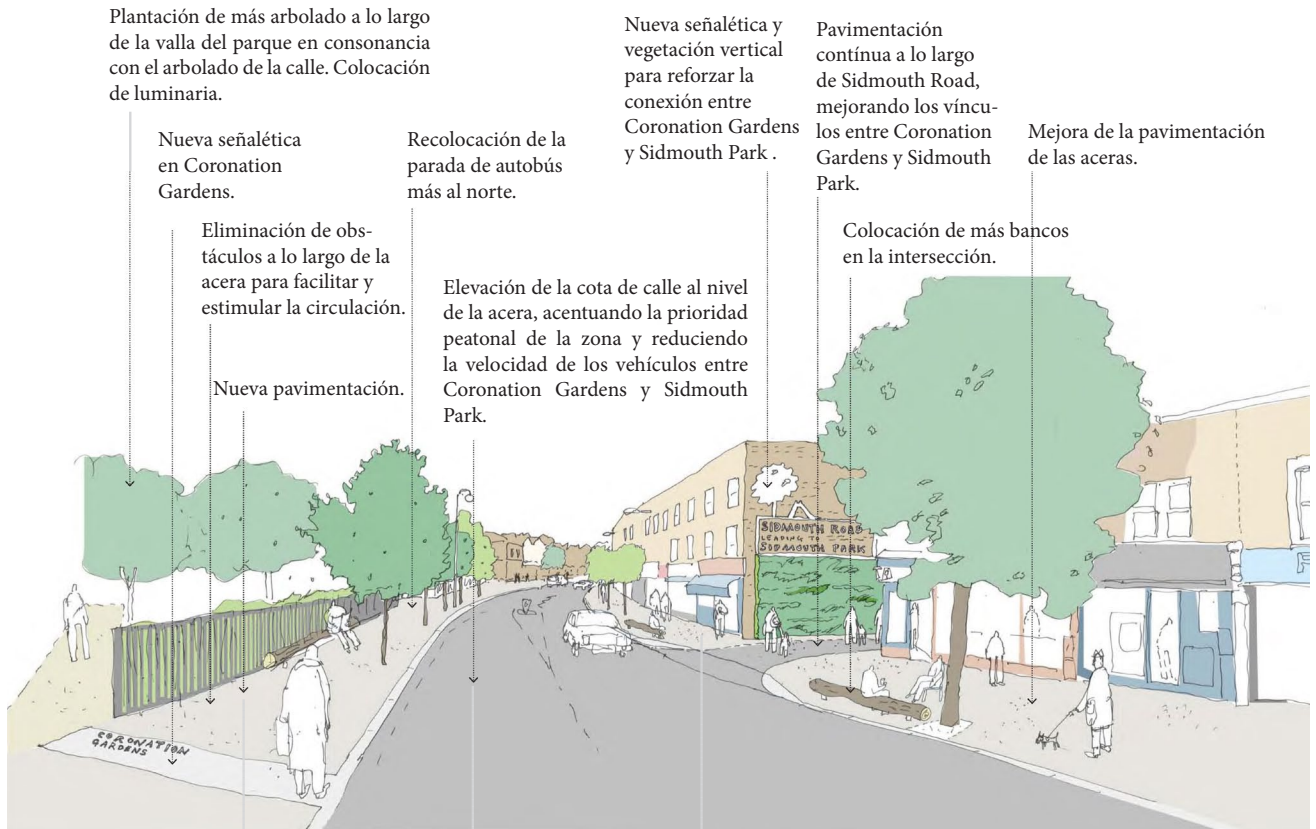
II.105 Imagen de la nivelación de calle y acera y la nueva pavimentación
