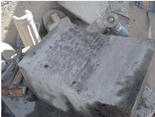
Figura 80. a) Superficie de molienda desprendida. b) Emparejando con la cortadora. Fuente: elaboración propia.
