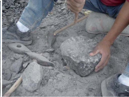
Figura 54. a) Rotación de la preforma. b) Intervención en la cara dorsal. Fuente: elaboración propia.
