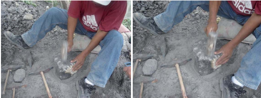
Figura 51. a) Uso del marro. b) Formación de la cara dorsal del molcajete. Fuente: elaboración propia.
