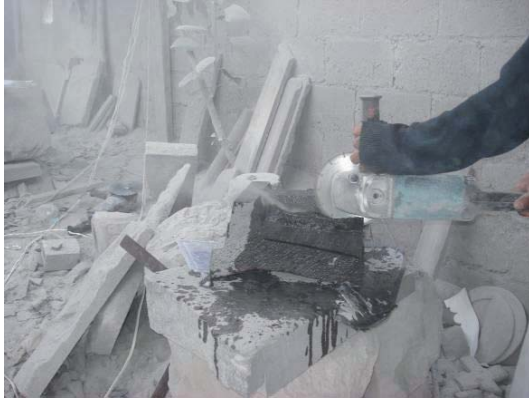
Figura 91. a) Corte para vaciar la parte central. b) Desbastando con el martillo. Fuente: elaboración propia.
