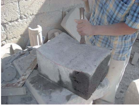
Figura 82. a) Delineando la superficie de molienda. b) Picando para dar textura. Fuente: elaboración propia.
