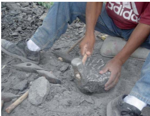
Figura 55. a) y b) Delineando la cara dorsal con el marro. Fuente: elaboración propia.
