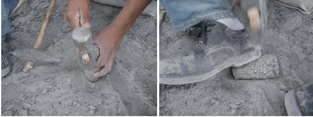
Figura 61. a) Desbaste con el marro. b) Sujeción con los pies. Fuente: elaboración propia.
