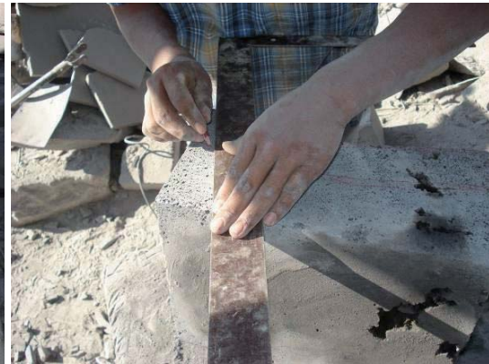
Figura 83. a) Superficie de molienda terminada. b) Trazando los soportes distales. Fuente: elaboración propia.
