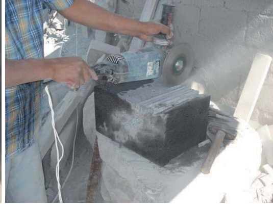
Figura 76. a) y b) Incisiones paralelas. Fuente: elaboración propia.
