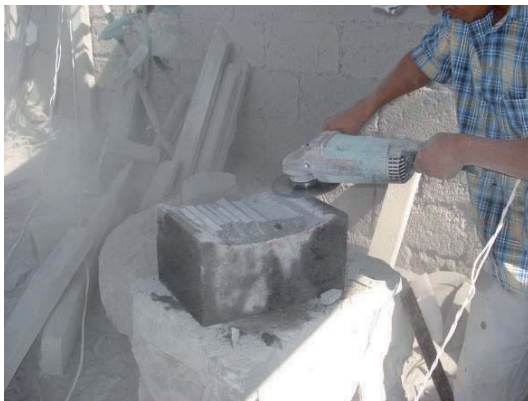
Figura 78. a) Emparejando con la cortadora eléctrica. b) Desprendiendo con el martillo. Fuente: elaboración propia.
