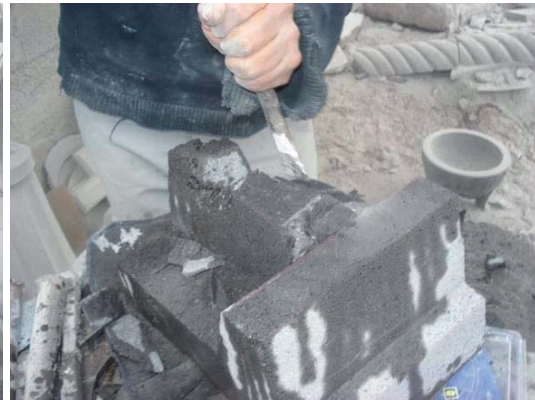
Figura 92. a) Corte interior del soporte. b) Desbaste de lo cortado. Fuente: elaboración propia.
