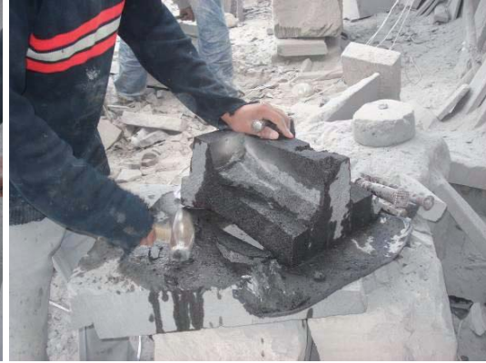
Figura 91. a) Corte para vaciar la parte central. b) Desbastando con el martillo. Fuente: elaboración propia.
