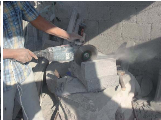
Figura 87. a) Trazando soporte cara ventral. b) Cortando sobre lo trazado. Fuente: elaboración propia.
