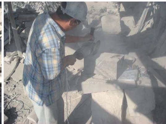
Figura 84. a) Trazando grosor de superficie de molienda. b). Cortando sobre el trazo. Fuente: elaboración propia.
