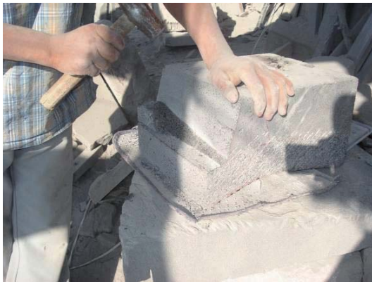
Figura 86. a) Desprendimiento con el martillo. b) Acabado de la extremidad distal. Fuente: elaboración propia.
