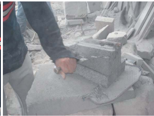
Figura 89. a) Corte longitudinal. b) Desbastando lo cortado. Fuente: elaboración propia.
