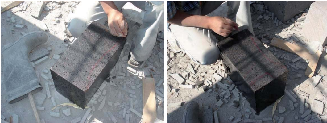
Figura 73. a) y b) Trazado de la superficie de molienda. Fuente: elaboración propia.
