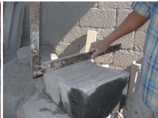
Figura 81. a) Comprobando las dimensiones. b) Verificando la superficie de molienda. Fuente: elaboración propia.
