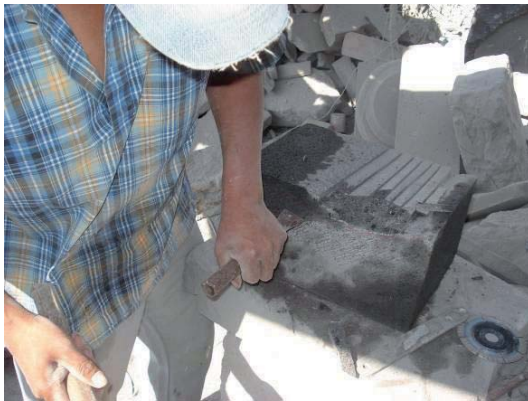
Figura 77. a) y b) Desbastando con cincel y martillo. Fuente: elaboración propia.
