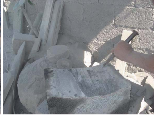
Figura 79. a) Observando donde intervenir. b) Desprendiendo con el cincel y martillo. Fuente: elaboración propia.
