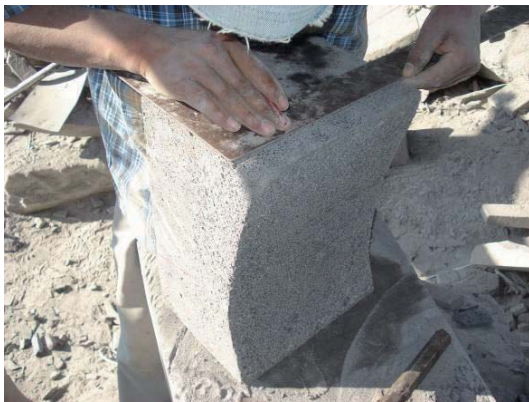
Figura 84. a) Trazando grosor de superficie de molienda. b). Cortando sobre el trazo. Fuente: elaboración propia.
