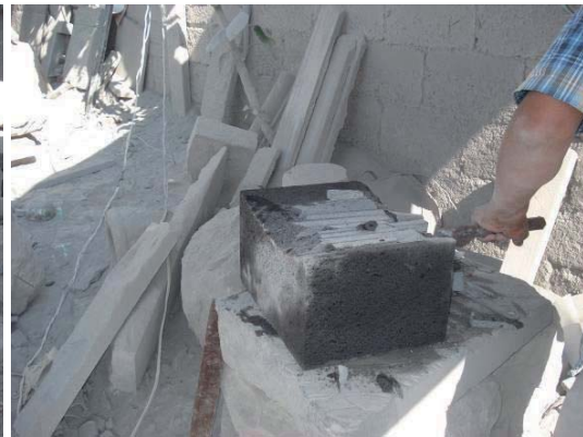
Figura 77. a) y b) Desbastando con cincel y martillo. Fuente: elaboración propia.
