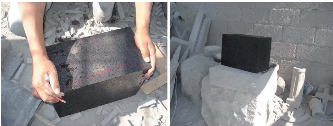
Figura 74. a) Trazando a un costado. b) Bloque trazado y listo para ser intervenido. Fuente: elaboración propia.
