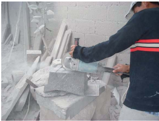
Figura 89. a) Corte longitudinal. b) Desbastando lo cortado. Fuente: elaboración propia.
