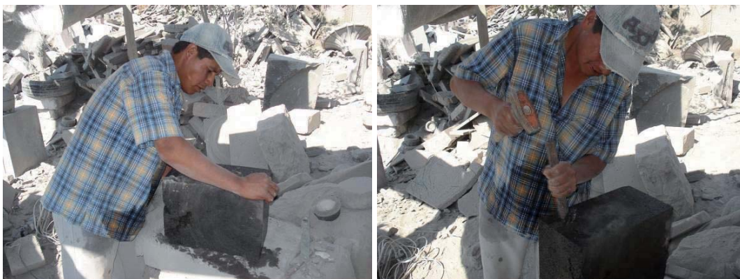
Figura 75. a) Acomodando el bloque. b) Marcando con el martillo. Fuente: elaboración propia.
