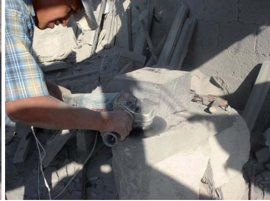
Figura 85. a) Desprendimiento con el martillo. b) Cortando de tanto en tanto. Fuente: elaboración propia.
