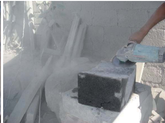
Figura 80. a) Superficie de molienda desprendida. b) Emparejando con la cortadora. Fuente: elaboración propia.
