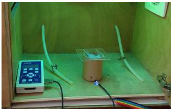
Figura 13. Montaje del radiómetro para detección UV.
