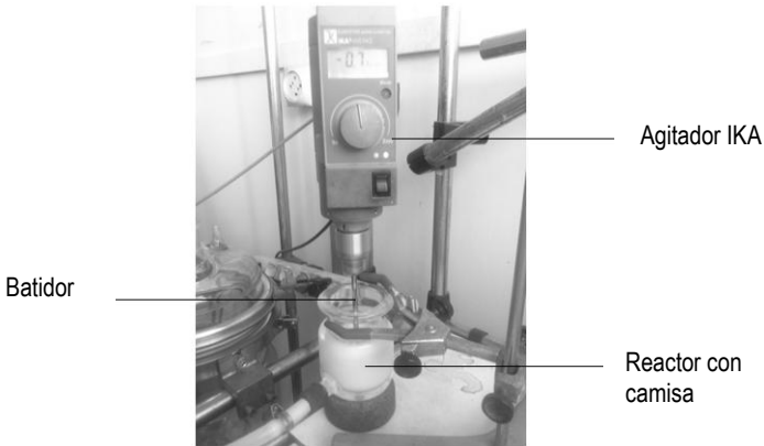
Figura 8. Dispositivo utilizado para el montado de la crema de leche.
