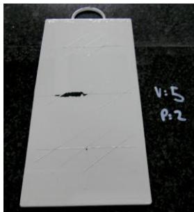
Figura 17. Panel STD para el experimento 1 con test de adherencia para OEM2.
