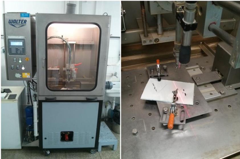
Figura 12. *Steam jet tester* de WalterCleaningSystems®. En la imagen de la izquierda se observa una vista completa del equipo y en la derecha se puede ver cómo se posicionan las muestras en su interior.
