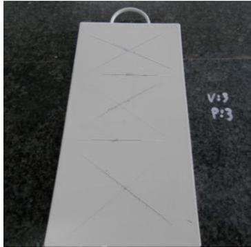
Figura 20. Panel STD después de pasar el test de adherencia para la OEM1.
