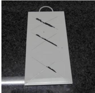
Figura 16. Panel STD para el experimento 1 con test de adherencia para OEM1.
