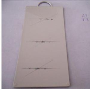
Figura 24. Panel STD después de pasar el test de adherencia para la OEM1 a 75°C.
