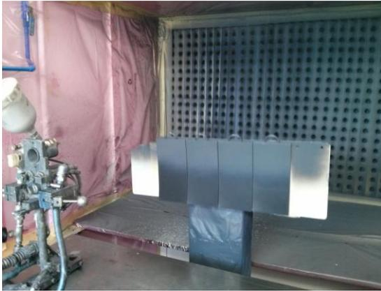
Figura 8. Aplicación de la imprimación en robot RX-20 sobre paneles de PP.
