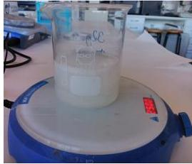
Figura 11. Sistema de agitación para la deshidratación de los productos
