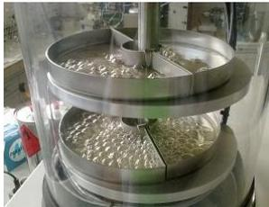
Figura 38. Aspecto del producto durante el proceso de secado convencional
