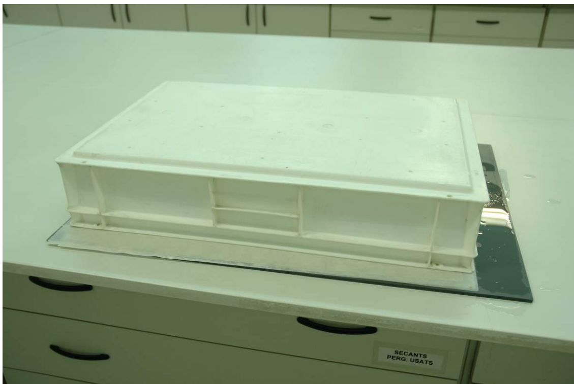
Humidificació dels fulls amb un símil de càmera d'humitat, per tal d'aplanar-los
