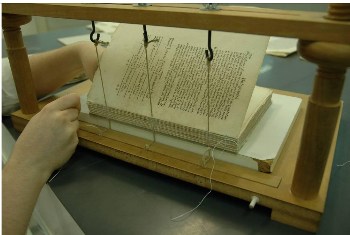
Relligat del bloc del llibre amb tres nervis de cordill
