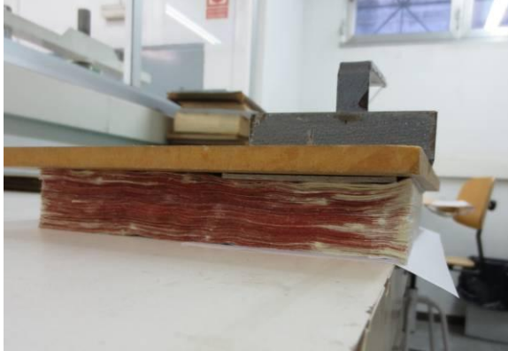
Llom del llibre després d'haver-hi aplicat l'adhesiu
