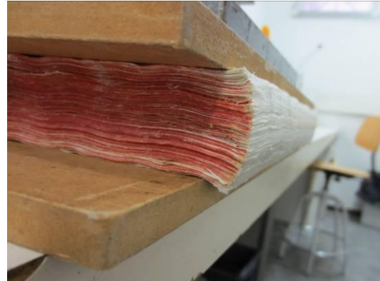
Detall del llom del llibre un cop arrodonit
