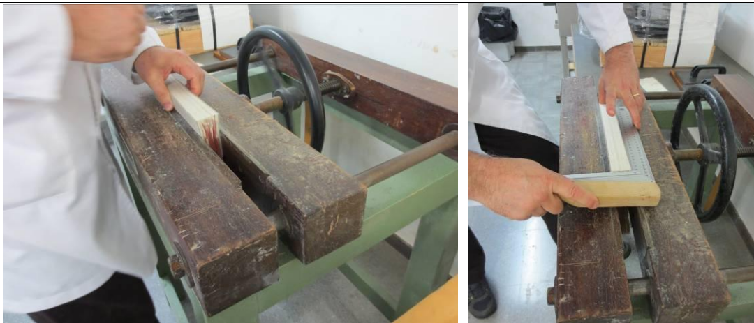
Col·locació del llibre en el burro d'enquadernació i escairat del conjunt de quaderns
