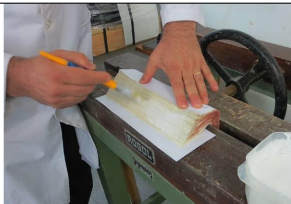
Encolat del llom del llibre amb Acetat de Polivinil diluït en aigua
