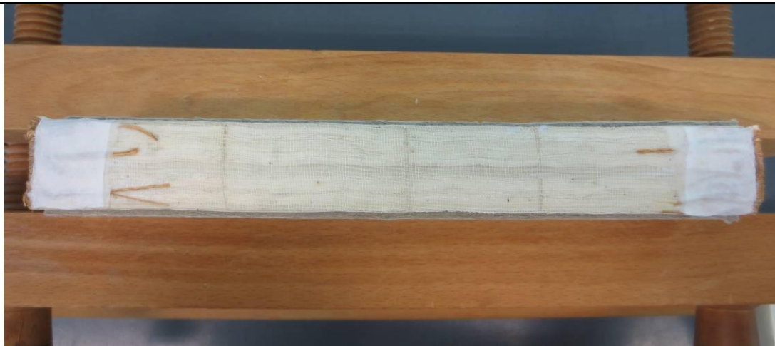
Llom del llibre després d'haver-hi adherit la tarlatana i les capçades
