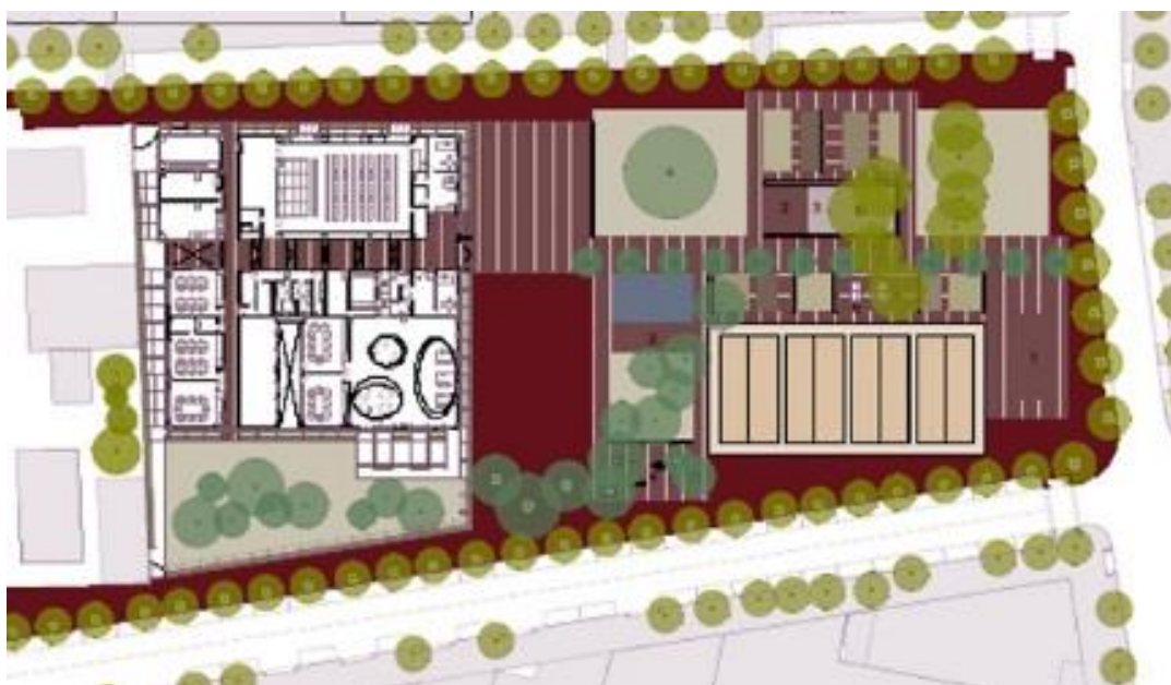
Fig.492>Proposta d'avantprojecte de la plaça del nou centre cívic de Baró de Viver. Només s'han tingut en compte algunes de les propostes veïnals com el paviment asfaltat de color vermell o el nombre de camps de petanca. Ha desaparegut els diferents elements dissenyats en els tallers participatius: jocs infantils, l'espai d'aigua; els elements simbòlics. L'opinió dels presents a la reunió és que el projecte no farà que el lloc esdevingui un espai distintiu; s'interpreta que és una proposta poc treballada. Font: CRPolis
