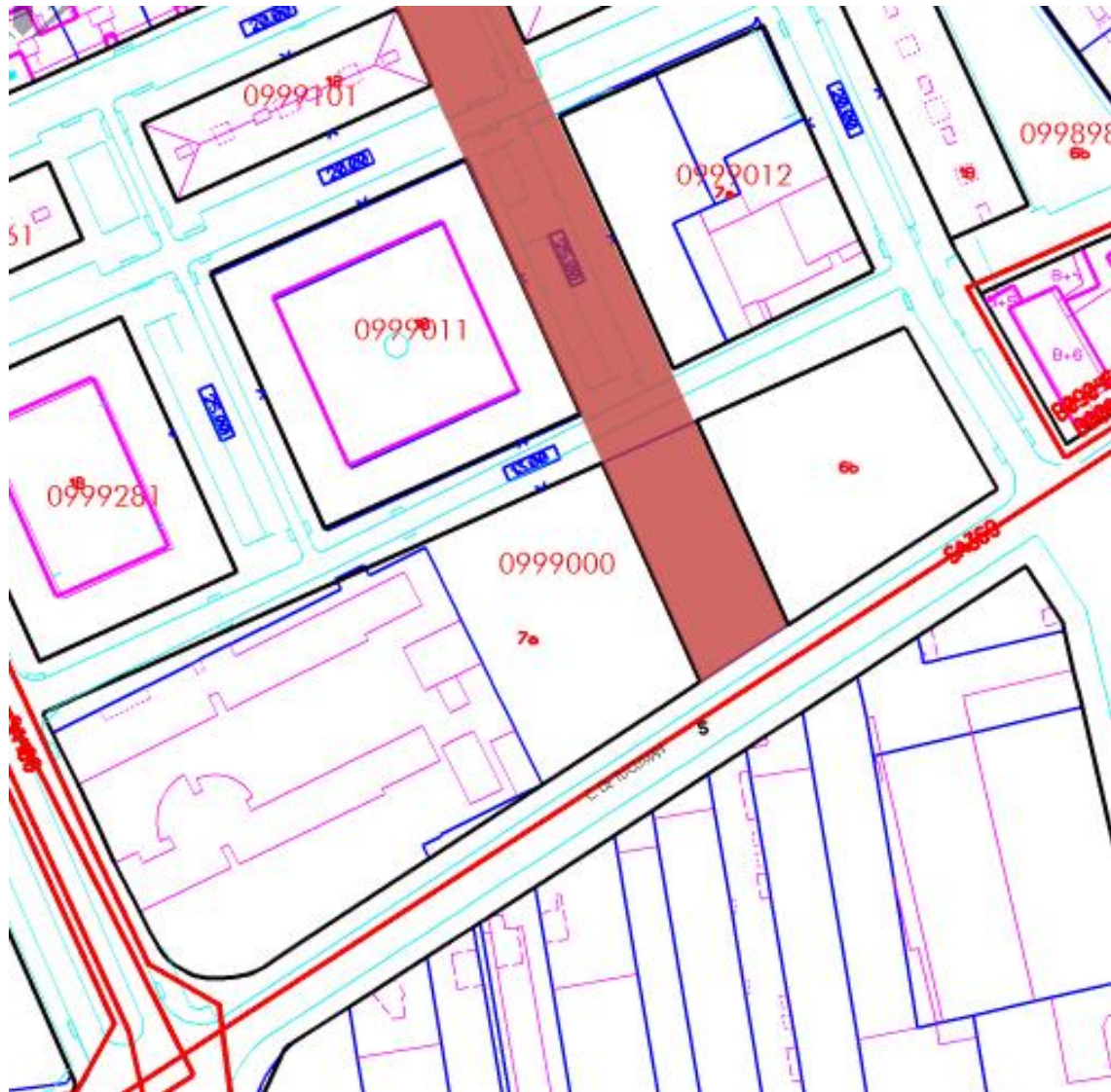
Fig.370>Plànol urbanístic del sector on s'ha assenyalat el C/Beat Domènec Savio, que divideix la proposta de l'àmbit de la plaça en dos sectors. A l'esquerra, enganxat a CEIP Baró de Viver la qualificació és 7a (equipaments). És on es preveu construir la residència de dia i el casal d'avis. A la dreta del carrer, l'espai és qualificat de 6b (zona verda). És l'espai que el veïns/es poden fer part de la seva proposta. Font:CRPolis
