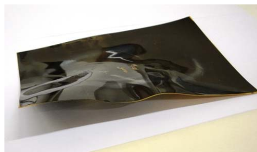
Figura 7: Deformacions del pla de la pel·lícula
