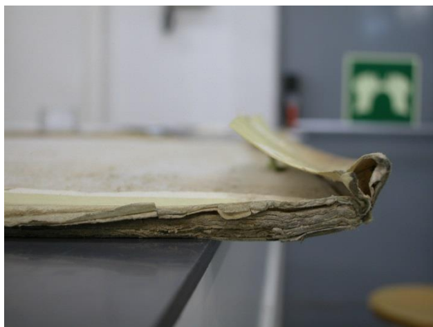
Desgast del voral del pergami, per ús i manipulació.
