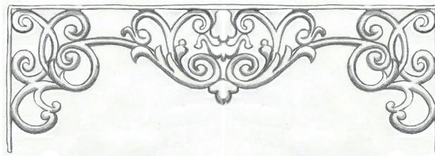
Diferentes tipos de antepecho en fundición que se usa como elemento de seguridad dado que las ventanas, por sus dimensiones aproximadas de 200 x 100 cm. Ubican su borde inferior a menos de un metro de altura.
