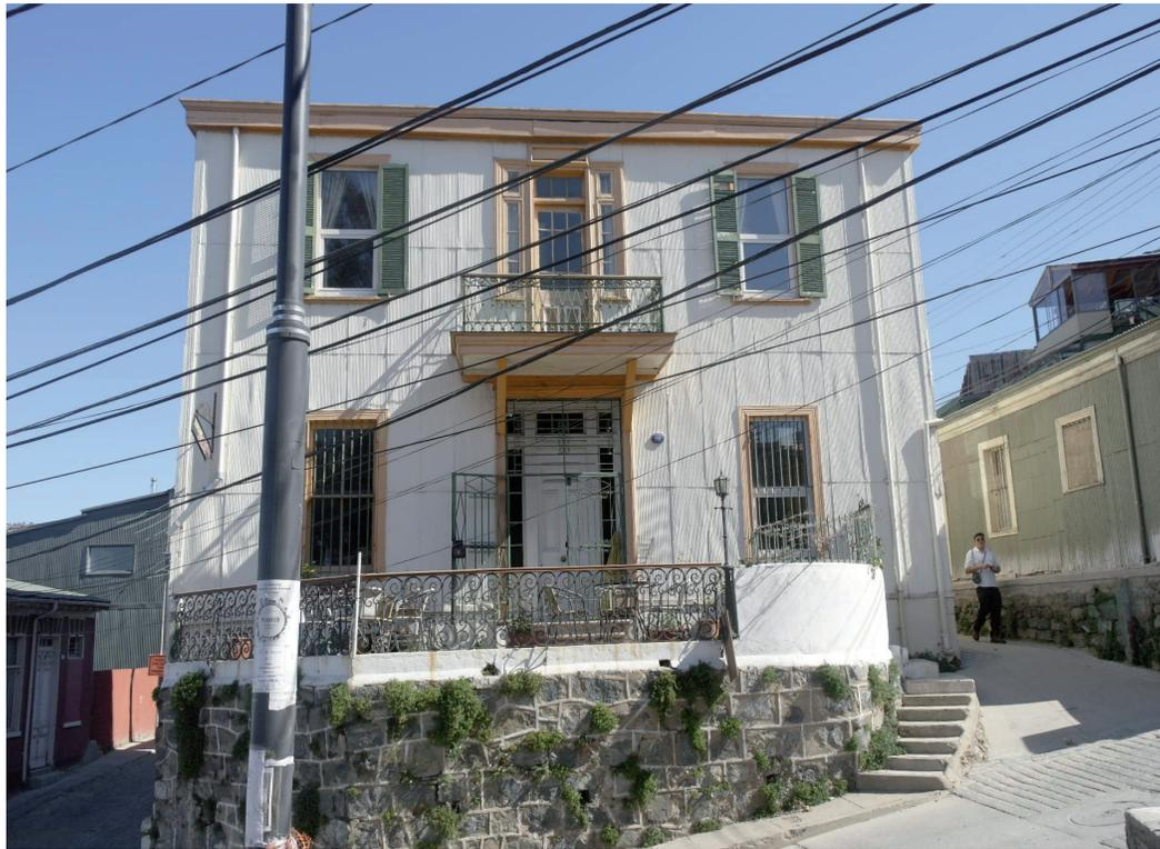
Fig 30. Construcciones en adobillo y calamina ubicadas en el cerro Cordillera y en el cerro Artillería
