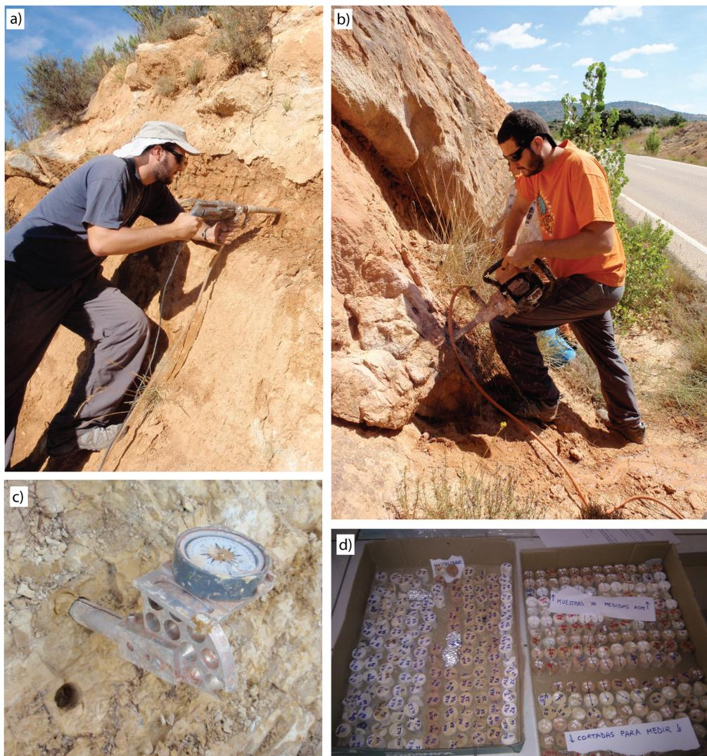
Fig. 4.2 (a) Perforación para muestreo en arcillas (perforadora eléctrica). (b) Perforación para muestreo en caliza (perforadora de gasolina). (c) Orientador de muestras. (d) Muestras cortadas.
