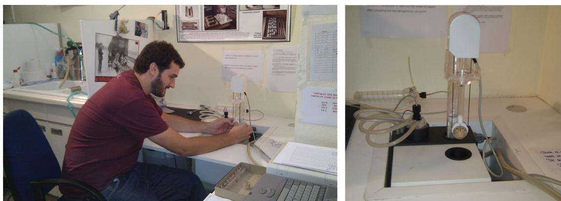
Fig. 4.3. Análisis de una muestra en el susceptibilímetro AGICO Kappabridge KLY3S del Laboratorio de Fábricas Magnéticas de la Universidad de Zaragoza
