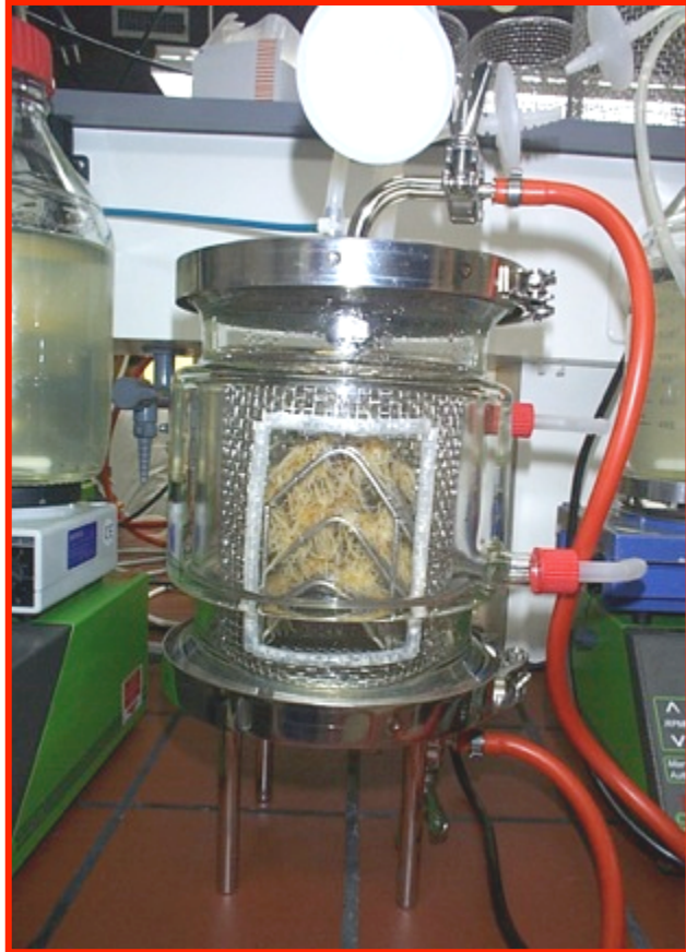
Cultiu d'arrels transformades de Panax ginseng en un bioreactor spray
