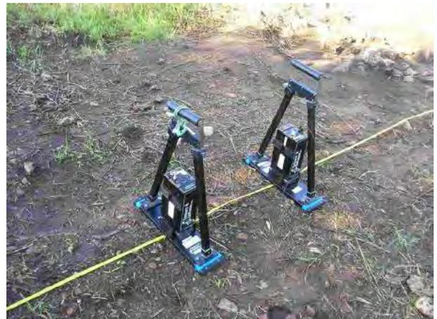
Fig. 3. Detalle de los equipos empleados. Izquierda: equipo de tomografía eléctrica. Derecha: detalle de las antenas emisora y receptora del GPR.
