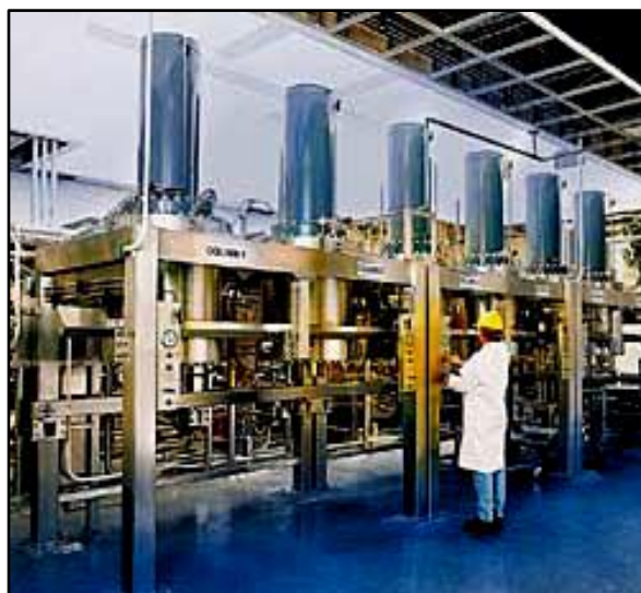
Figura 2.5. Estructura de la planta de SMB industrial- Licosep 6*800 . La unidad consta de 6 columnas de 800 mm de diámetro. Propiedad de Aerojet Fine Chemicals, Rancho Córdoba, CA.
