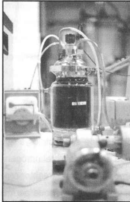
Figura 3.3. Detalle de las bombas peristálticas de llenado (abajo) y vaciado (izquierda) junto al reactor biológico.
